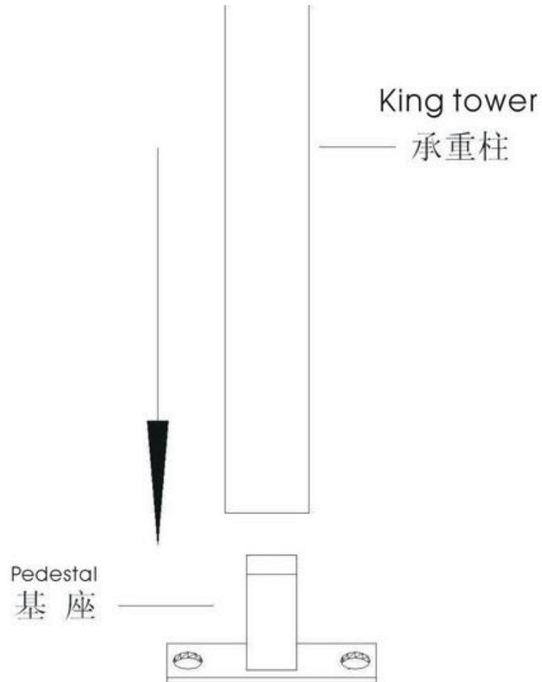
10. 承重柱底部连接基座，用螺丝固定高度。
