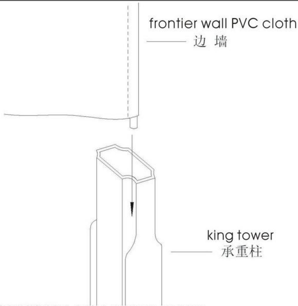
12. 将边墙有穿条部分的篷布插入承重柱上端的缺口内，拉至底部。
