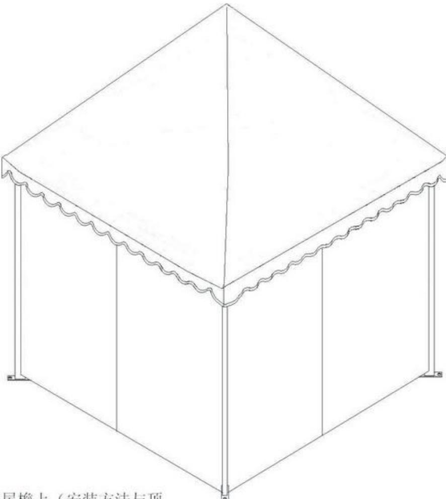
13. 将围边装在篷房屋檐上（安装方法与顶篷相同），此步后篷房搭建完成。
