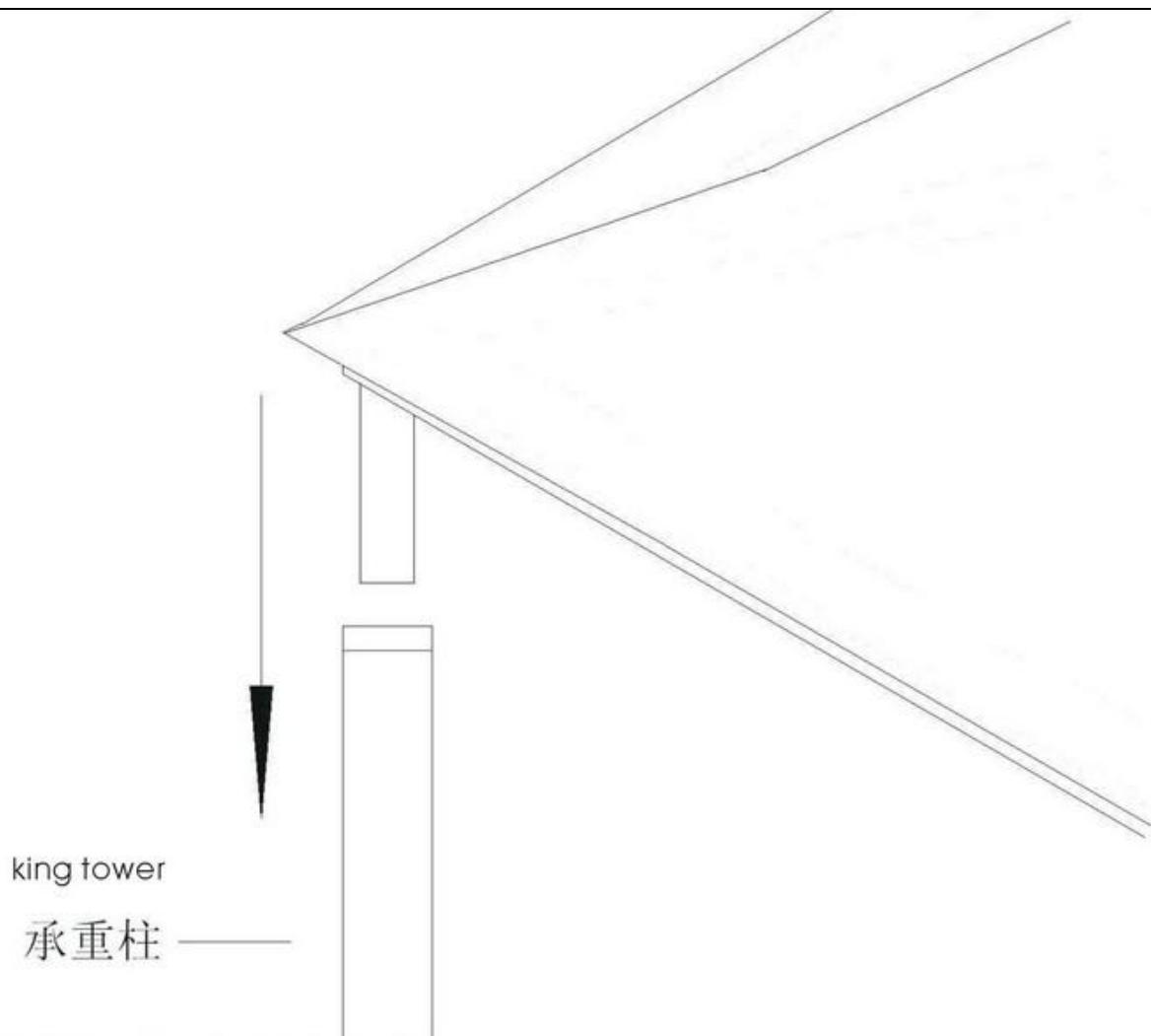
9. 用叉杆顶起篷房上端，4个角连接承重柱。
