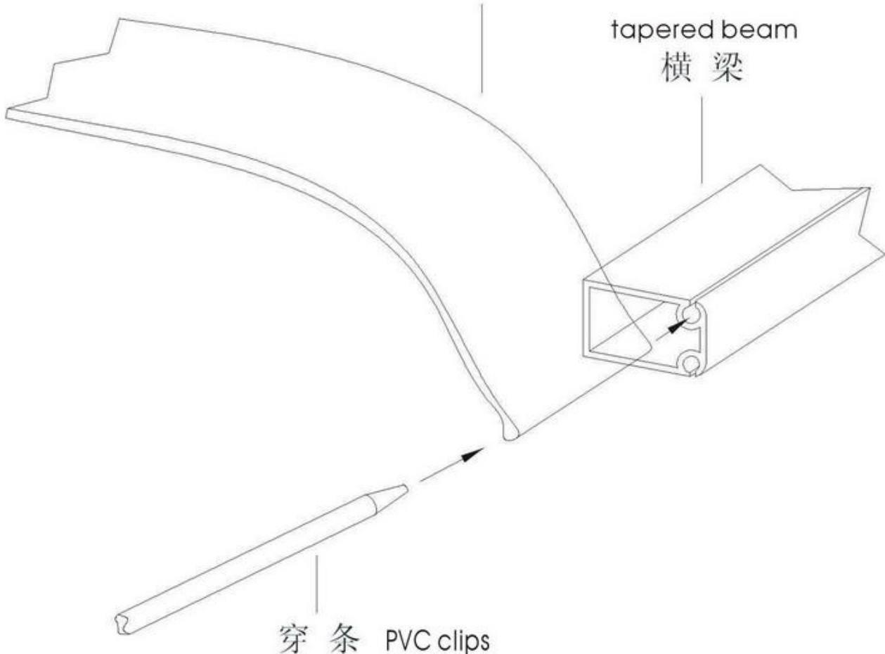
7. 用穿条将顶篷穿入横梁的孔内，4边穿完固定既可。
