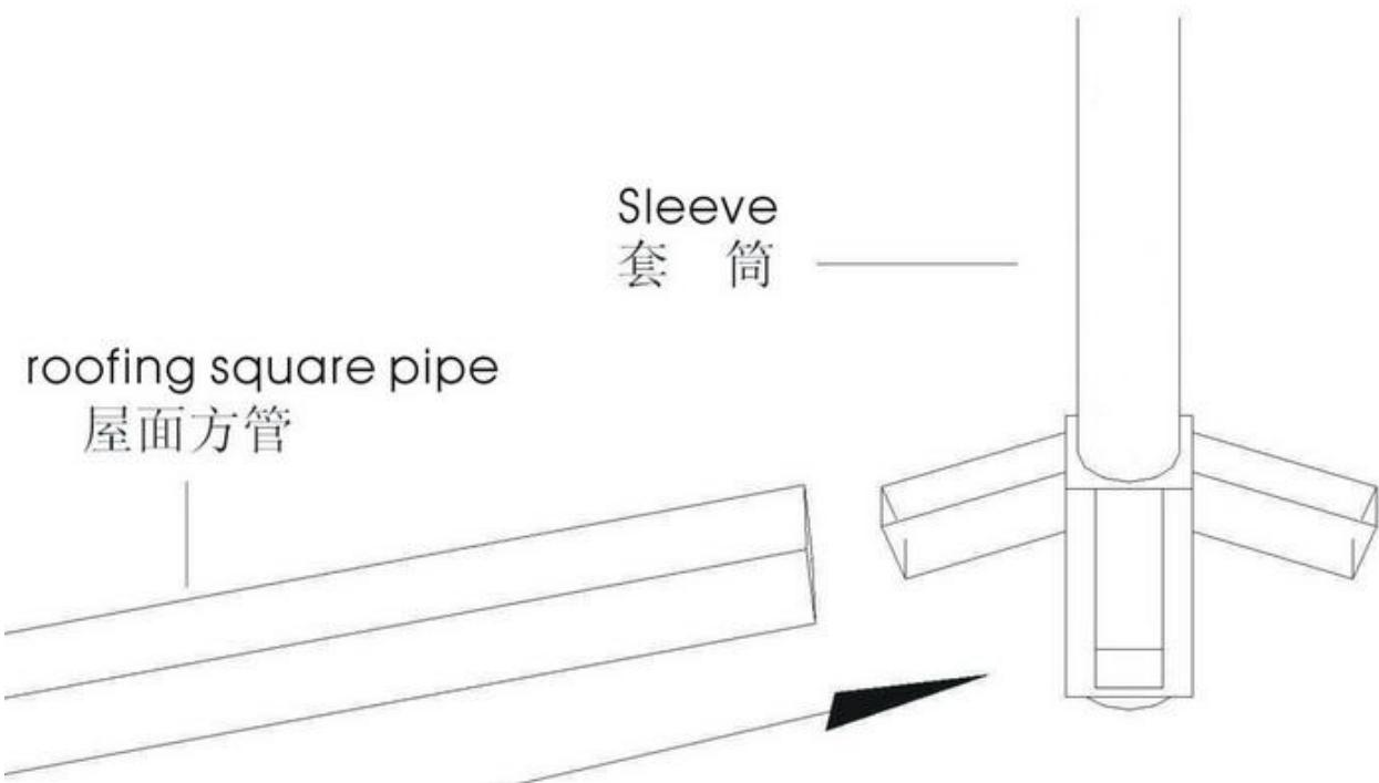
4. 将套筒的4个角插入屋面方管另一端。
